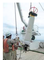
電磁流速計と電気伝導度・水温・水深計を搭載した超深海乱流計
