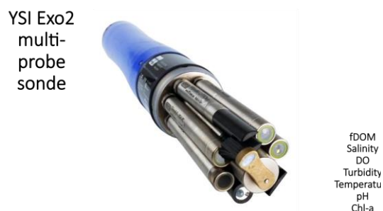
図 3. Jaffé 教授が使用されている多項目センサー (Jaffé 教授がセミナーで用いられたプレゼンテーションファイルから引用)
