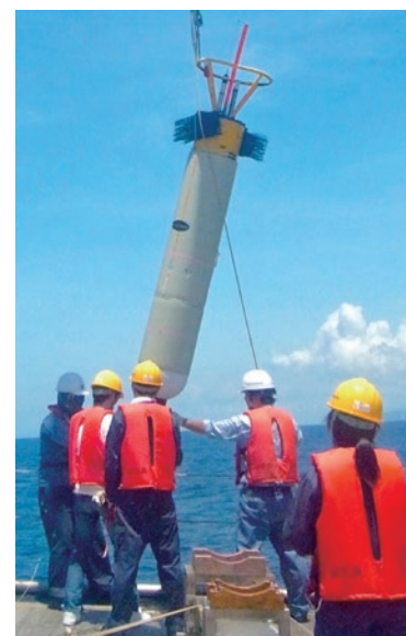
写真1:乱流計(VMP-5500)の投入風景
